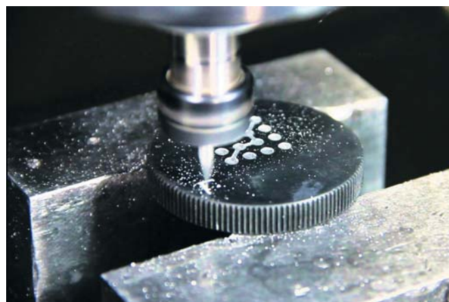
Рис. 2. Маркировка фрезерным оборудованием
